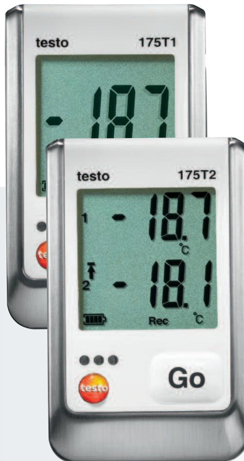
Testo 175 T1 è il data logger compatto per il monitoraggio a lungo termine di prodotti refrigerati e magazzini frigoriferi così come dei valori di temperatura nei mezzi di trasporto. L'ampia memoria e la lunga vita della batteria permettono di scaricare i dati ad intervalli di tempo maggiori, nonostante il ciclo di misura sia più breve. Il software gratuito ComSoft Basic consente una rapida programmazione e una facile
