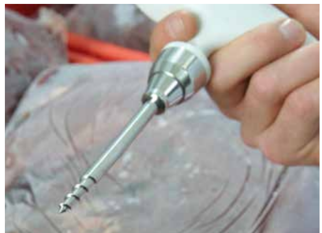
Controllo della temperatura nel reparto ricevimento merci con lo strumento testo 105
