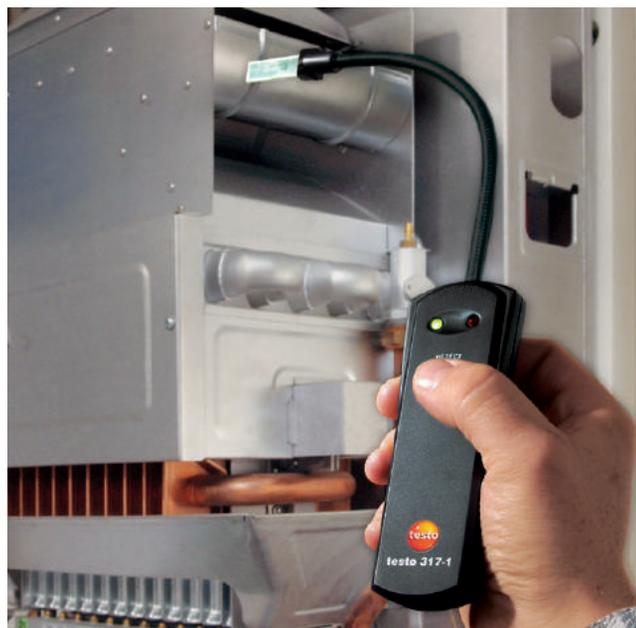
Uso del rilevatore di reflussi di gas testo 317-1
