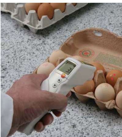
Figura 5: Misura senza contatto
