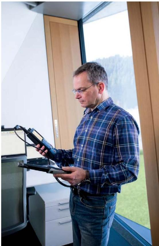
Fig. 3: Misurare la temperatura e l'umidità dell'aria ambiente usando lo strumento di misura del clima testo 480.
