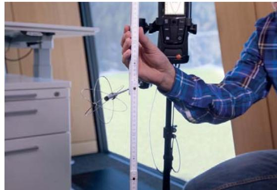
Fig. 9: Seconda misura delle correnti d'aria all'altezza del tavolo (0,6 m).
