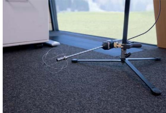
Fig. 8: Prima misura delle correnti d'aria a un'altezza di 0,1 m da terra.
