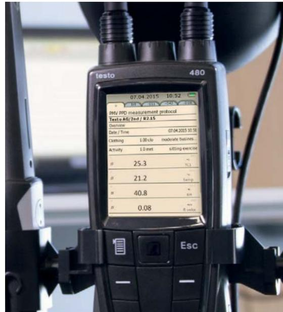
Fig. 11: Estratto del protocollo di misura.
